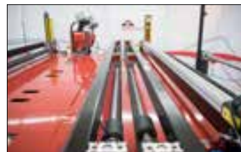
Verschillende verstelbare drukrollen, om verschillende maten doek te kunnen bewerken.
